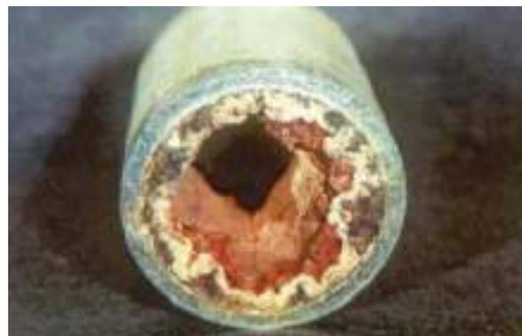
**Figura 4 – incrustação em tubulação de condensado**
