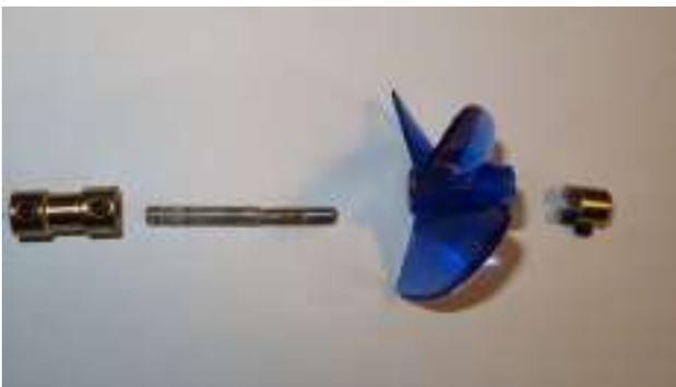
**Figura 4 - Conjunto acoplador e hélice.**
