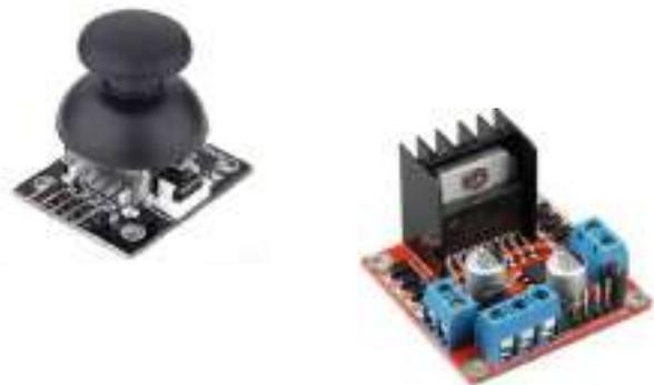
**Figura 9 - Módulo Joystick para Arduino, com 3 eixos e Driver Ponte H L298N**
